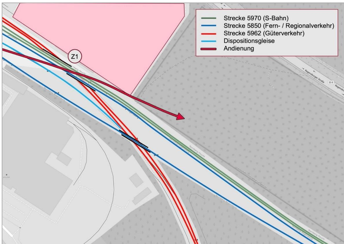
Abb. B.18 Detaildarstellung des Zugang Z1, welcher die S-Bahngleise (Strecke 5970) höhengleich kreuzt
