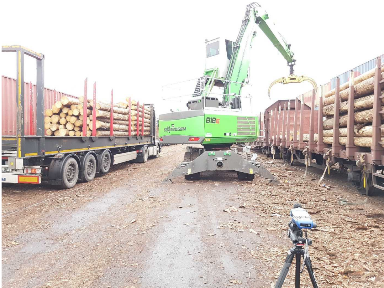
Abbildung 18: Messung Umschlaggerät Bagger Sennebogen 818E (Messg. "Rundholz_SLM_001")
