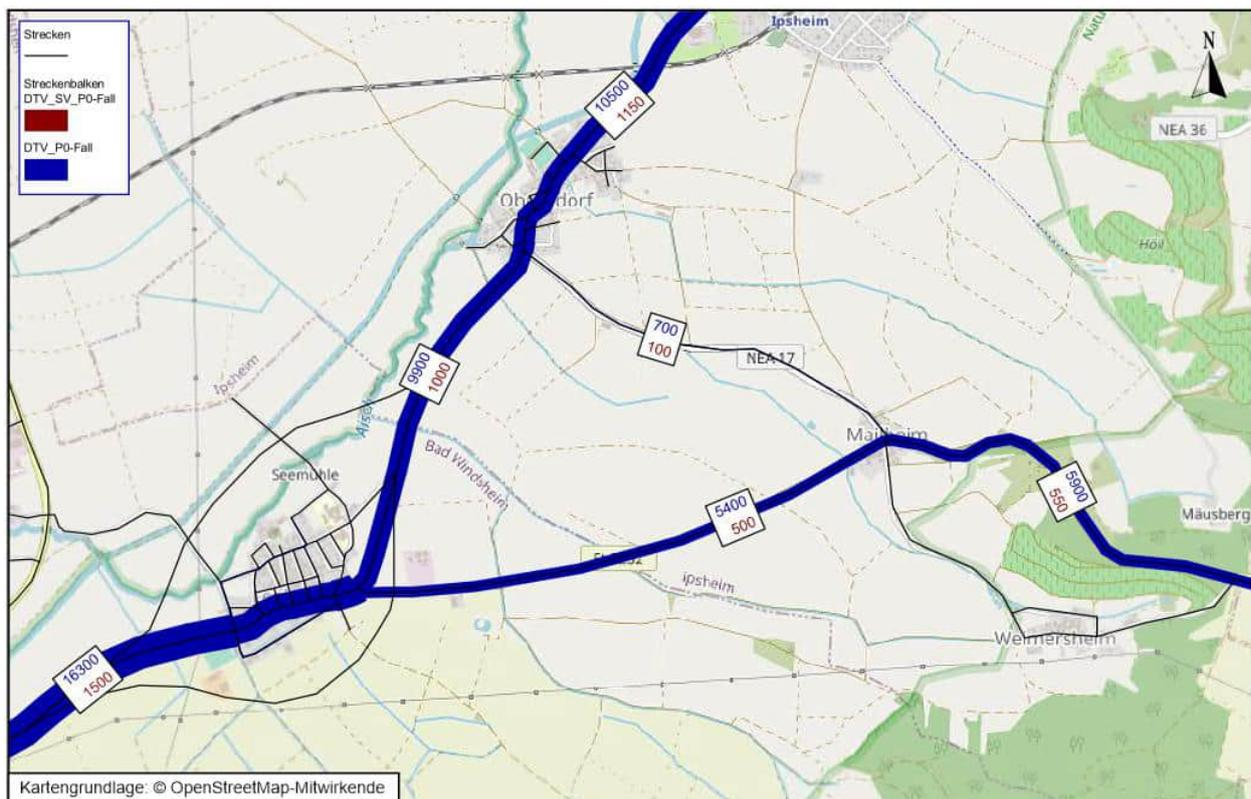
**Abbildung 6:** Durchschnittliche tägliche Verkehrsstärke (DTV) [Kfz/24h] [SV/24h] im Prognose-Nullfall
