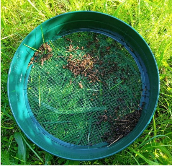
Abb. 7: Sieb mit Maschenbreite 3mm
