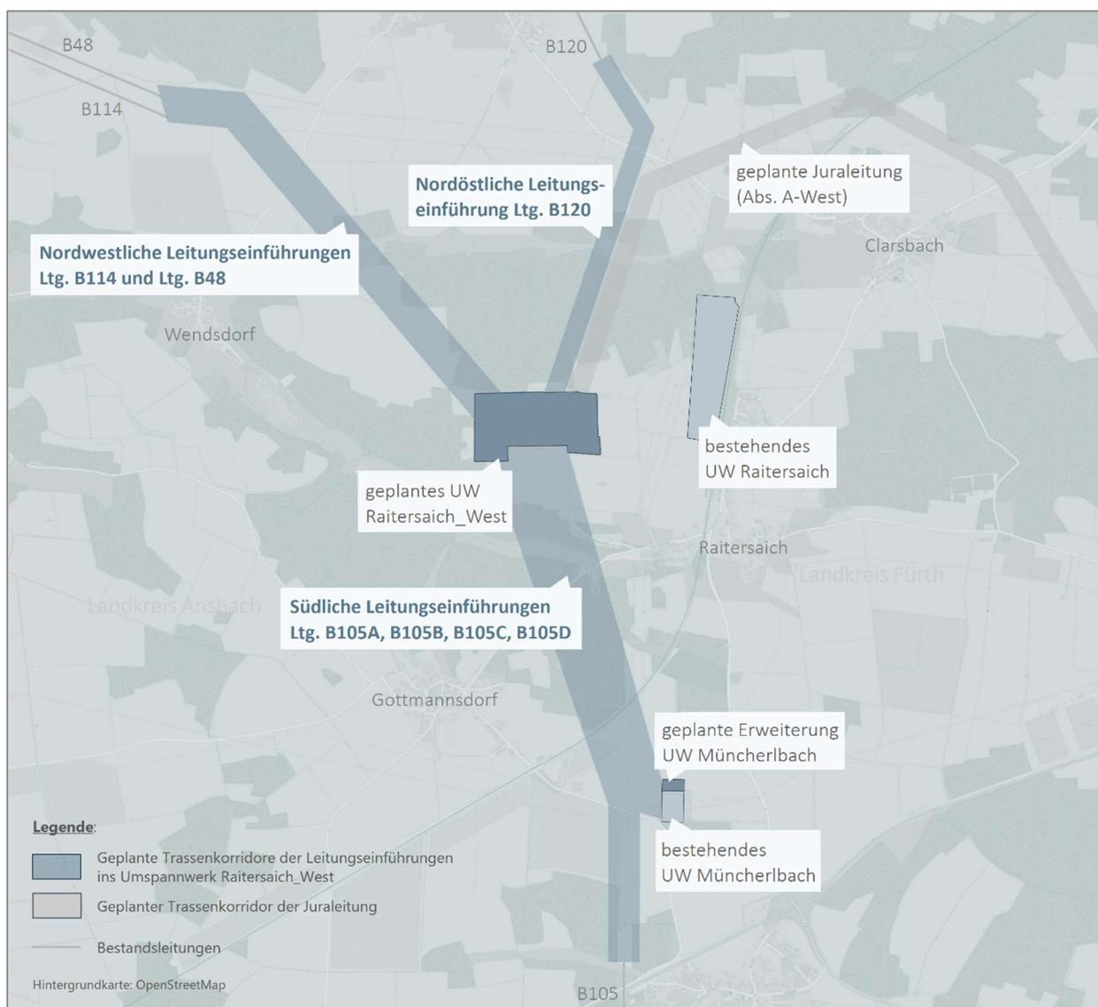
**Abbildung 1:** Geplante Trassenkorridore (Skizze) der Leitungseinführungen in das neue Umspannwerk RAIW (Quelle: Tennet TSO GmbH, OpenStreetMap).
