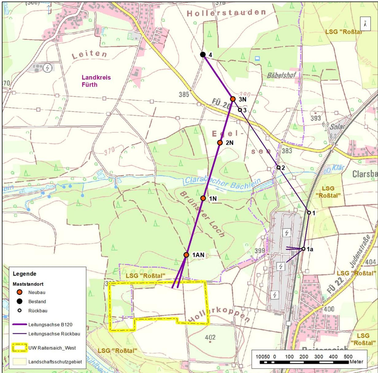
Abbildung 1: Lageplan der nordöstlichen Leitungseinführung zum UW Raitersaich\_West
