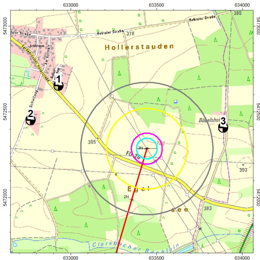
Abbildung 2: Trassenverlauf/Standort Mast Nr. 3N Neubautrasse im Bereich des Ortsteils Fernabrünst
