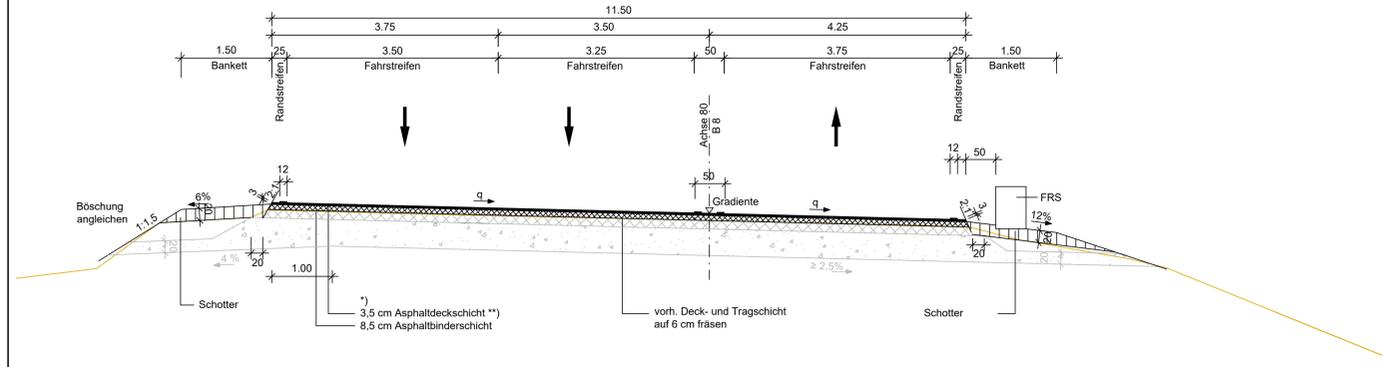
vorhandener 3-streifiger Querschnitt Richtung Würzburg
