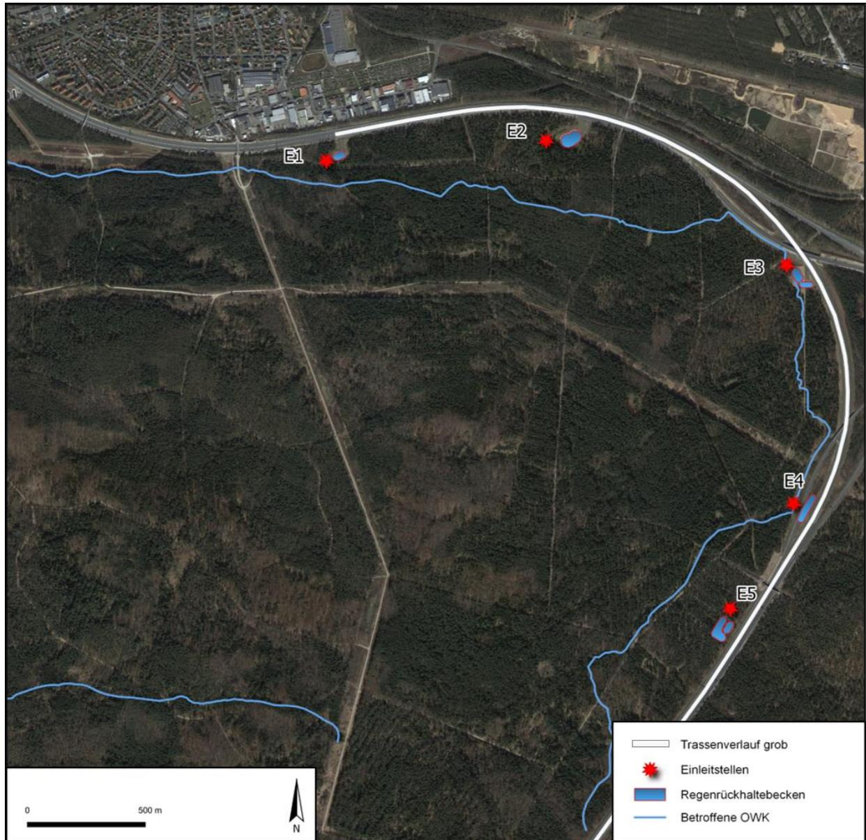
**Abbildung 7: Lage der Entwässerungsanlagen und Einleitstellen sowie grobe Trassenlage (nördlicher Abschnitt)**
