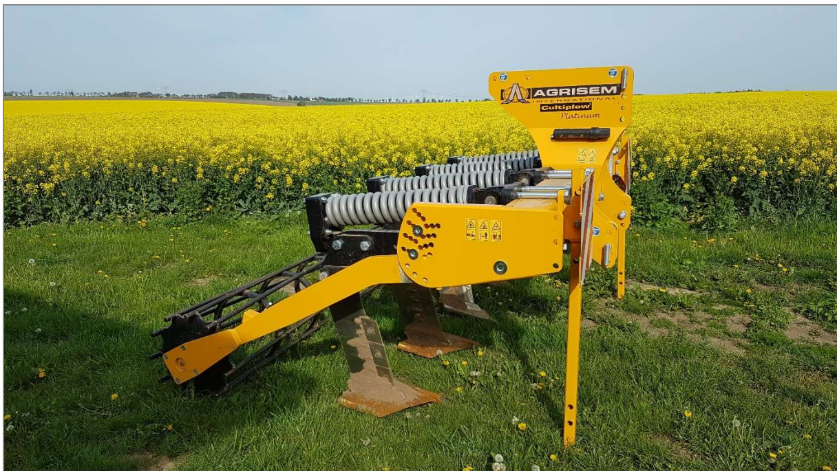
Abbildung 9: Beispiel eines sehr gut geeigneten landwirtschaftlichen Tiefenlockerers.
