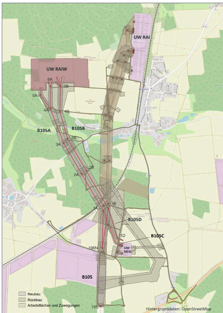
Abbildung 1: Übersicht der Südlichen Leitungseinführungen ins UW RAIW (Stand Juni 2024)
