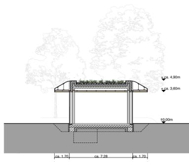
Querschnitt Funktionsgebäude I M 1:200
