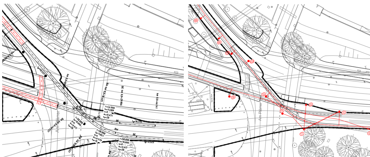
Abbildung 52: Gleis- und Fahrleitungsprovisorium
