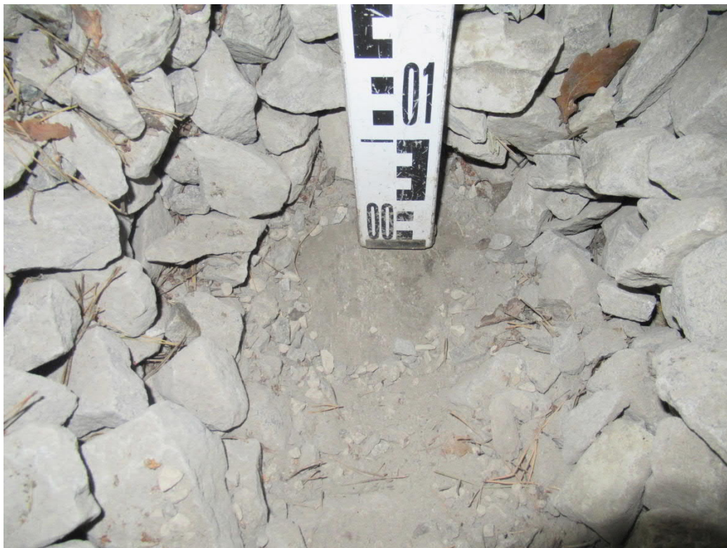
Bild 2: Detailfoto S 1, 0,0 – 0,45 m u. Schwellen OK, Beton ohne bituminöse Feuchtigkeitssperre
