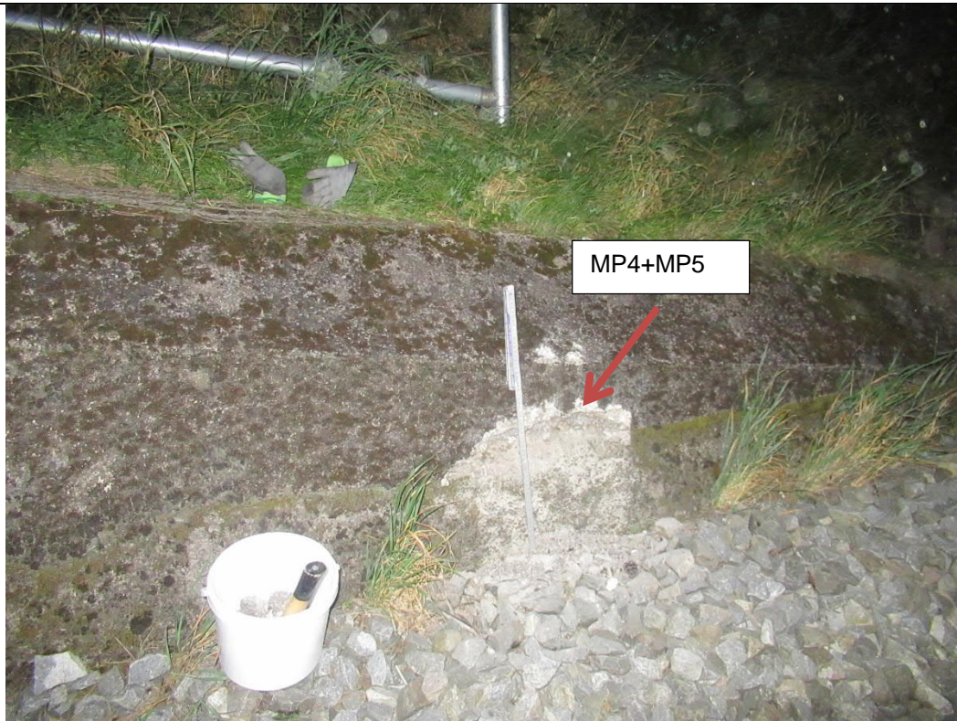
Bild 11: Detailfoto Abschlagproben der Stützwand (MP4+MP5 / Lfd.-Nr. 4)
