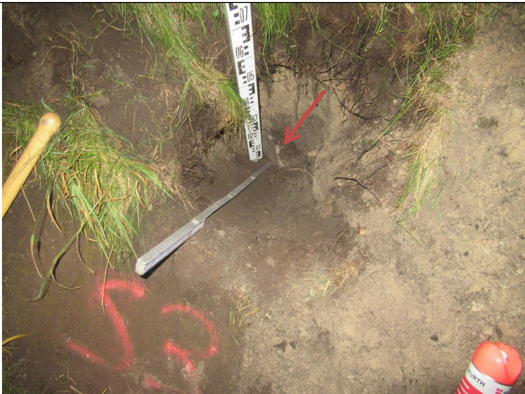
Bild 8: Detailfoto Stützwand, kein Schwarzanstrich erkennbar
