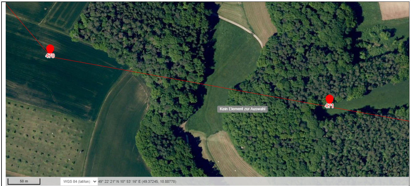
Abbildung 10: Erosionskanten im Geländeerelief zu erkennen, Bereich Masten 470 bis 471, oben Geländeerelief, unten Orthofoto aus Bayern Atlas [9], muss in diesem Bereich im Zuge des Leitungsbaues der Bewuchs (Wald) entfernt werden ist ein stabilisierender Vegetationsdecke herzustellen um Erosion zu vermeiden
