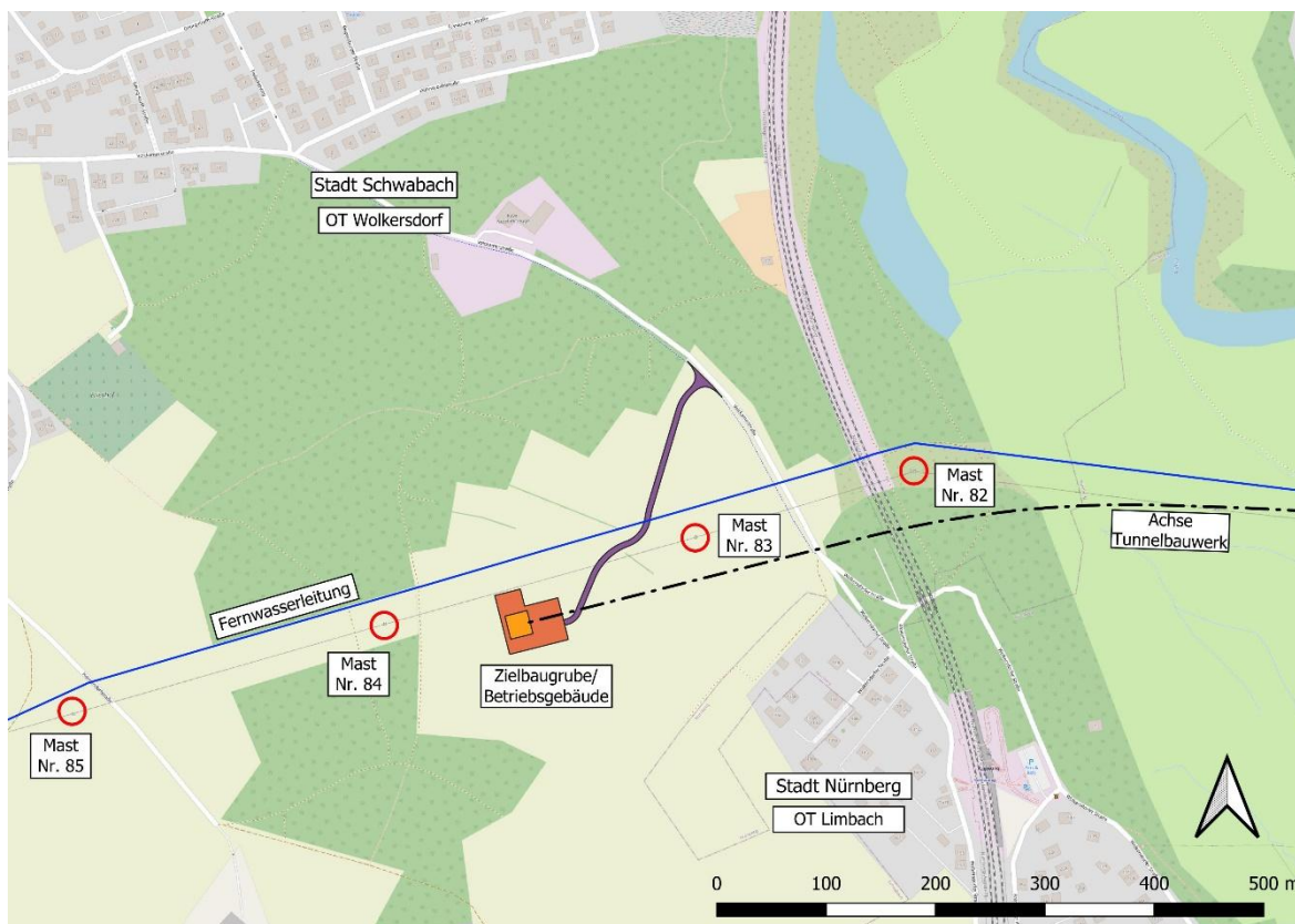
Abbildung 3: Schachtvariante a2 (südlich der Fernwasserleitung)
