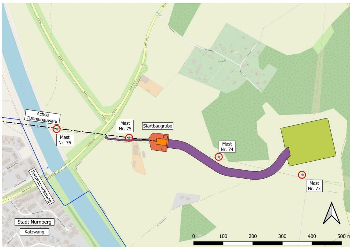
Abbildung 1: Schachtvariante a1 (östlich des Bestandsmastes Nr. 75)
