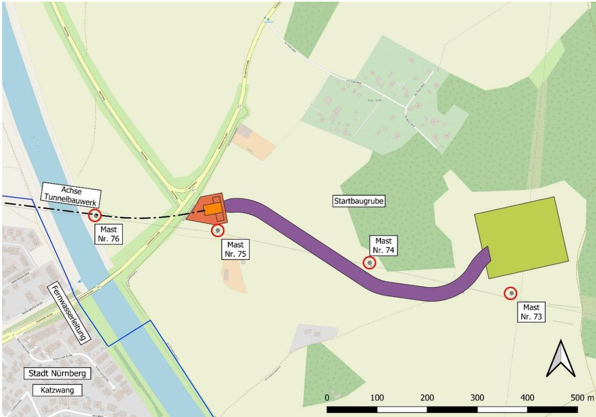
Abbildung 2: Schachtvariante a2 (nördlich des Bestandsmastes Nr. 75)
