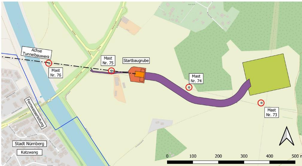
Abbildung 32: Schachtvariante a1 (östlich des Bestandsmastes Nr. 75)
